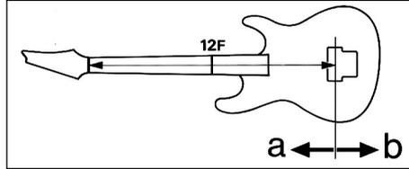
\* 正確なイントネーション調整にはチューニングメーターが必要です。特にサドルを後退させる場合は弦切れの原因になりますので、必ず弦をゆるめてから調整を行ってください。
