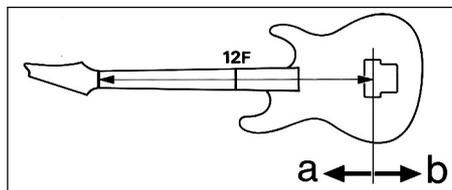
\* Remarque : le déplacement des sillets peut provoquer la rupture des cordes. Pour éviter cela, détendez toujours les cordes avant d'effectuer un tel réglage.
