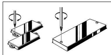
\* Bei Instrumenten mit einstellbaren Polstücken kann die Ausgangssignalstärke jeder Saite eingestellt werden.
