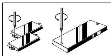
\* Les instruments possédant des pièces polaires réglages permettent d'ajuster la puissance de sortie pour chaque corde.
