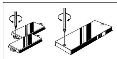
\* Los instrumentos provistos de pieza polar regulable se pueden ajustar para balancear el volumen de cada cuerda.
