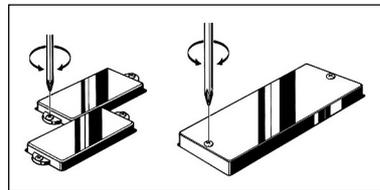
ほど音量が増えますが、近すぎると音ワレやピックアップの磁力による弦ビレの原因になります。逆に距離が遠いとひずみの少ないクリアな音色になりますが、高域が減少したり音量が低下してしまいます。
