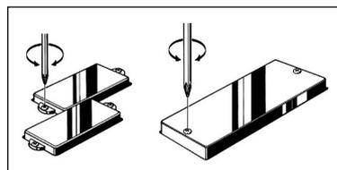
\* Gli strumenti che hanno pickup con poli regolabili possono essere regolati per bilanciare il segnale di uscita di ogni corda.
