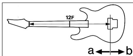
e il modo più accurato di impostare una lunghezza standard della scala. Con la nota armonica come standard, se la nota suonata sulla tastiera è calante, spostare la selletta del ponte in avanti in direzione della paletta dello strumento (a) per diminuire la lunghezza della corda. Se la nota è crescente, spostarla indietro rispetto alla paletta (b) per aumentare la lunghezza della corda.
